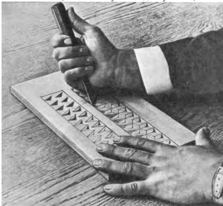
80а. Разновидности ножа-косячка. 80б. Работа ножом-косячком.
