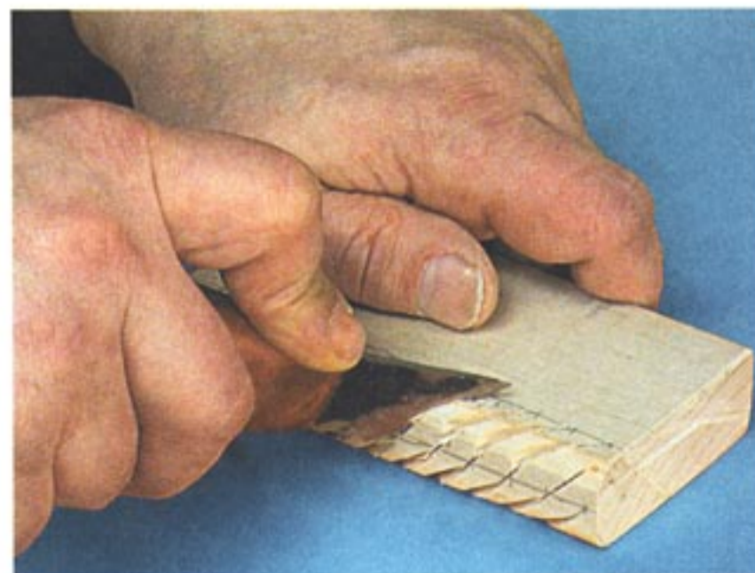
Рис. 83. Прорезка второй грани бруска ножом-косяком
