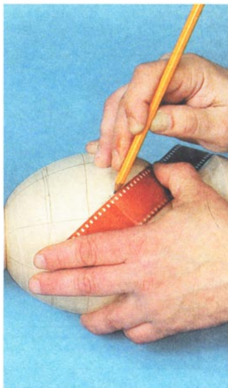
Рис. 138. Соединение точек координатной разметки на заготовке
