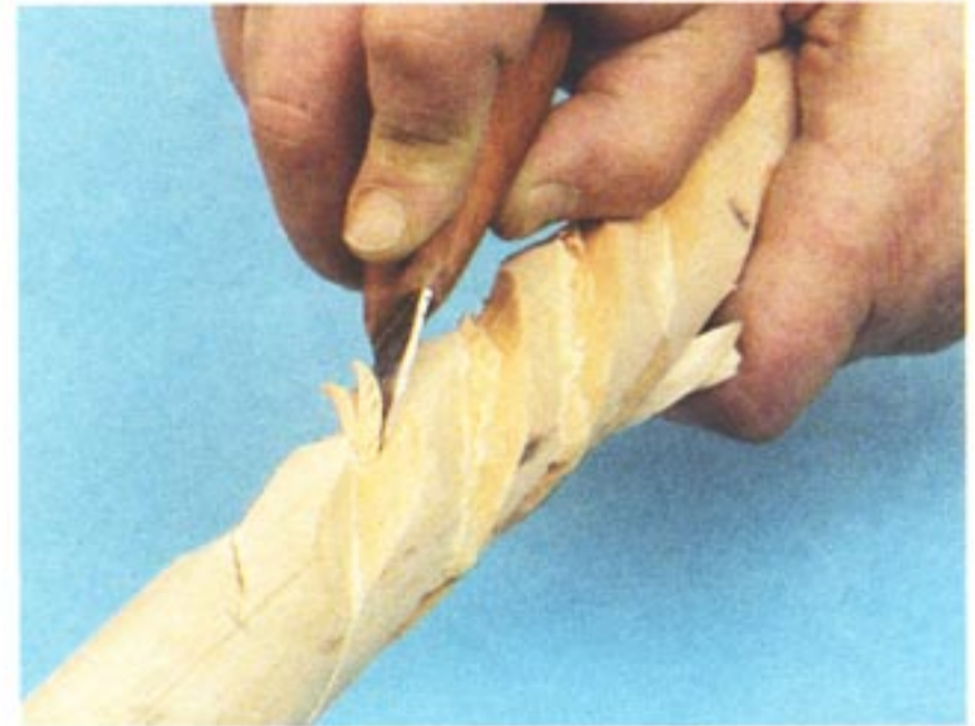
Рис. 121. Продолжение формирования граней (черновая прорезка) с одной стороны
