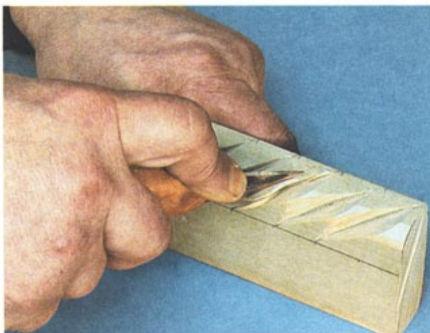
Рис. 58. Срезание лишнего материала по протилам с другой стороны
