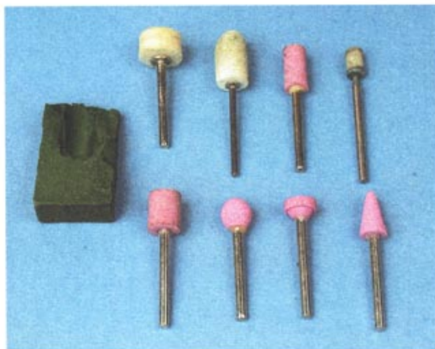
Рис. 41. Насадки для электроточила (боры): войлочные (верхний ряд) и абразивные (нижний ряд). Слева – паста ГОИ
