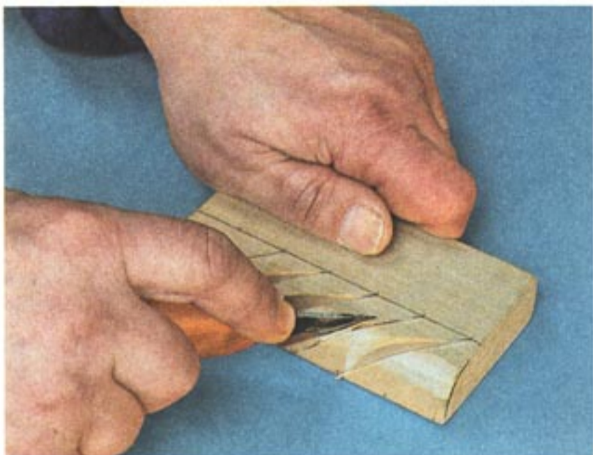
Рис. 57. Срезание лишнего материала по протилам с одной стороны
