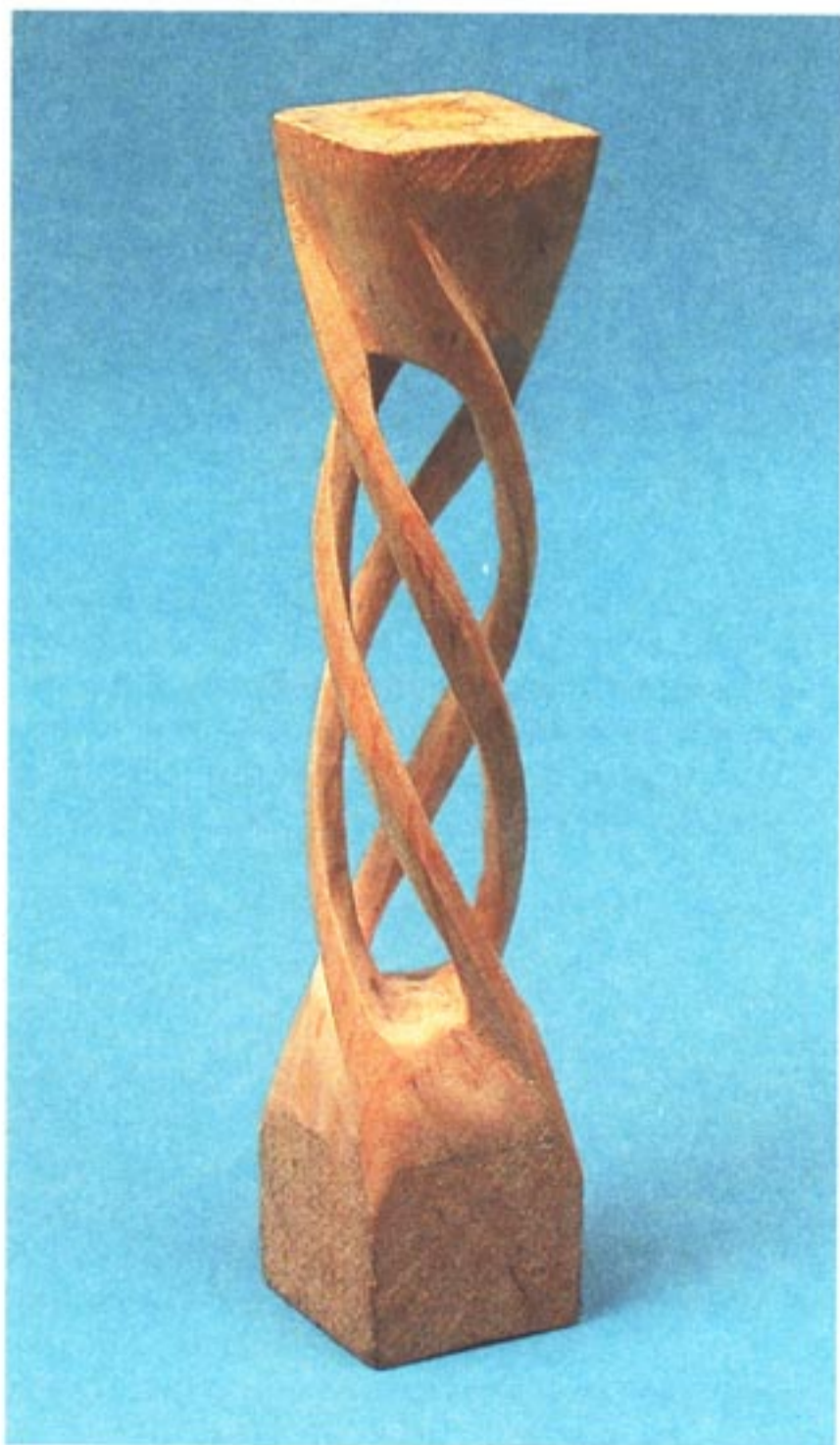
Рис. 147. Вид законченного прорезного винта после подчистки пробок
