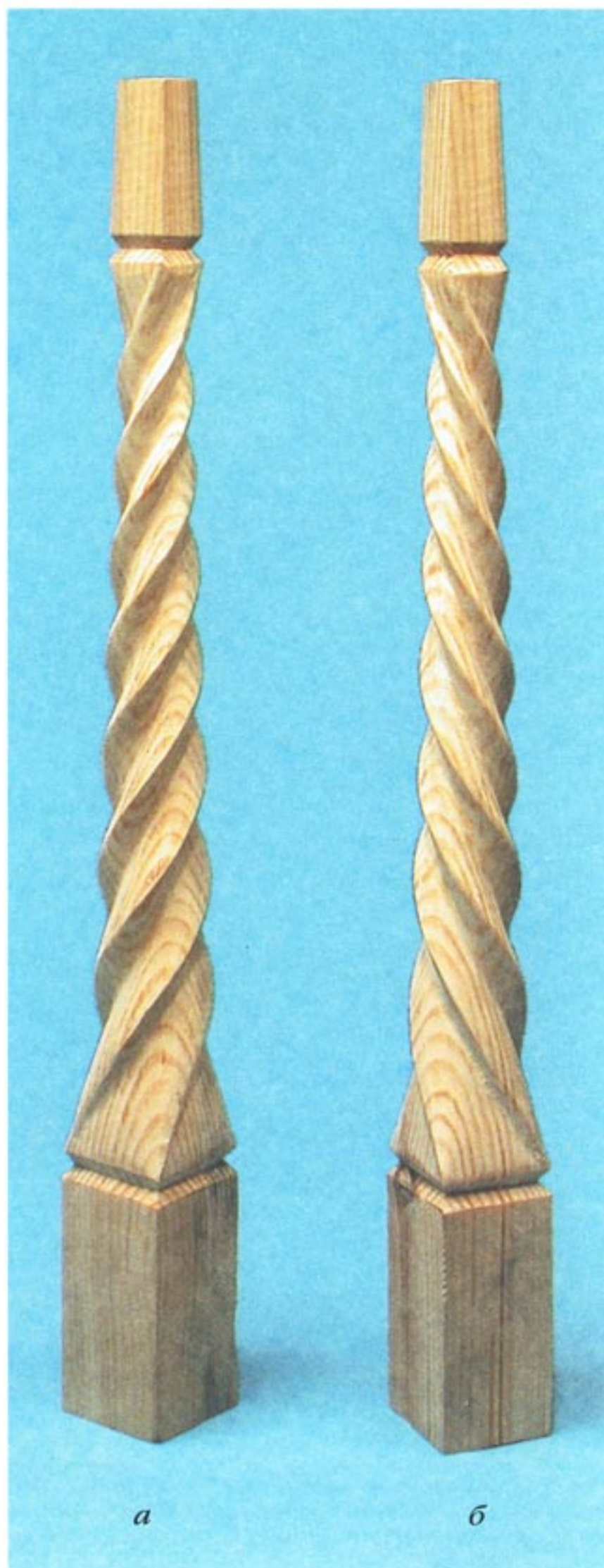
Рис. 133. Конусный винт, прорезанный на ножках столика по правой (а) и левой (б) разметке
