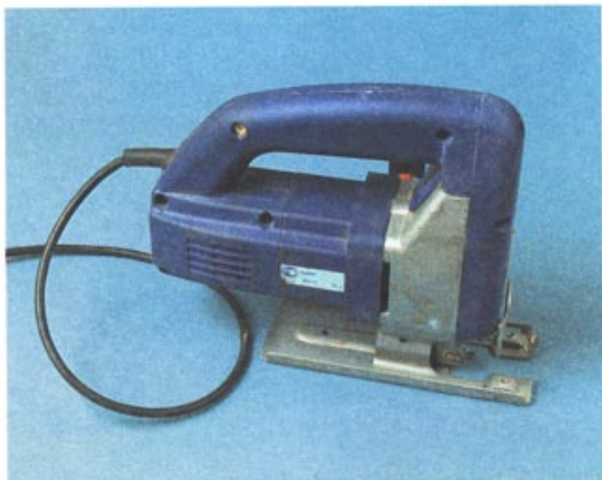
Рис. 38. Электроробзик с регулируемым углом наклона
