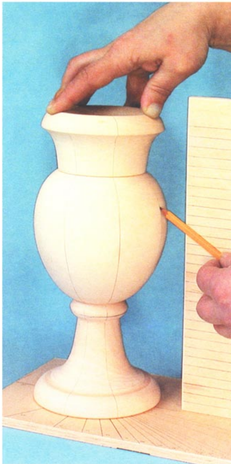
Рис. 136. Нанесение линий захода на заготовку при помощи приспособления для разметки
