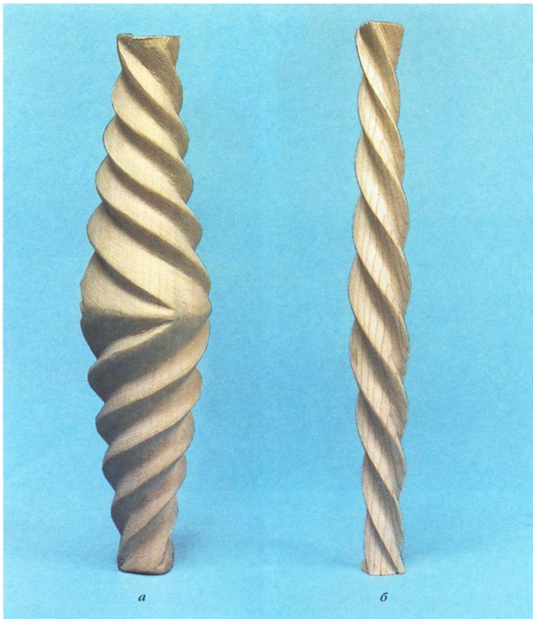
Рис. 134. Варианты винтов на заготовках, имеющих вид двухстороннего конуса: а – винты, прорезанные по правой и левой разметке, выполненной от центра; б – сквозной винт, прорезанный по разметке, выполненной от центра заготовки
