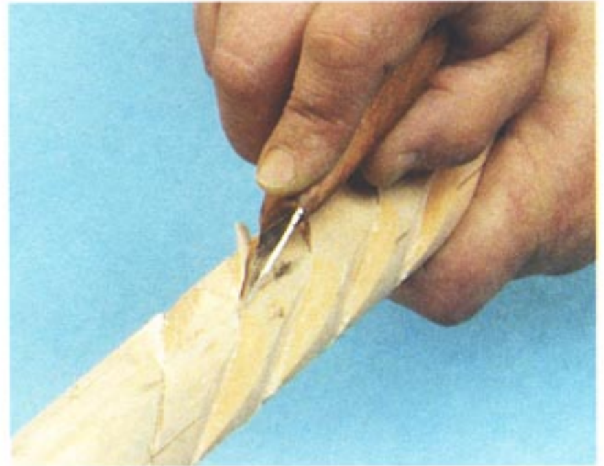
Рис. 120. Начало формирования граней (выполнение прорезки) после разворота заготовки
