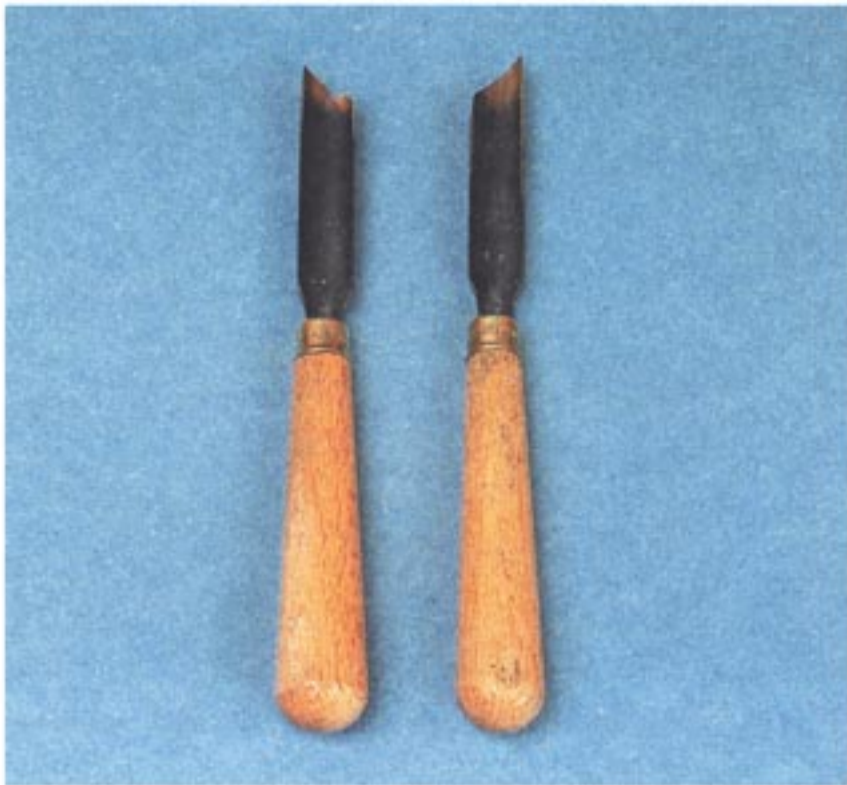
Рис. 29. Специальные полукруглые стамески со скошенной по углом 45^\circ режущей кромкой
