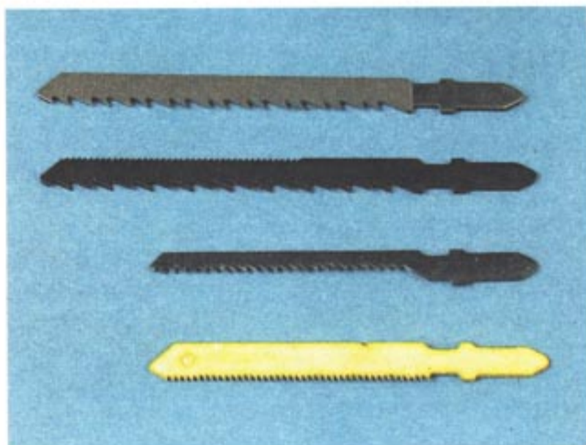
Рис. 39. Полотна для электроробзика, наиболее часто используемые для прорезки винта
