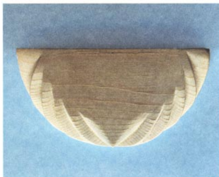
Рис. 67. Вариант 1/4 винта, проходящего по окружности при разметке от периферии
