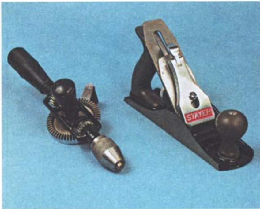
Рис. 33. Ручные дрель и рубанок с металлической подошвой
