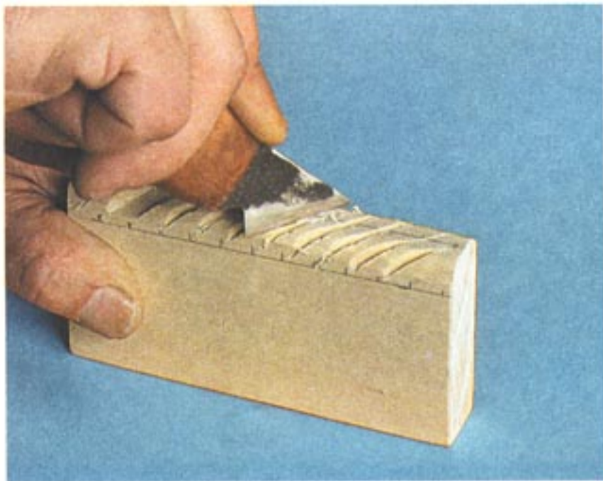
Рис. 84. Прорезка торца бруска ножом-косяком
