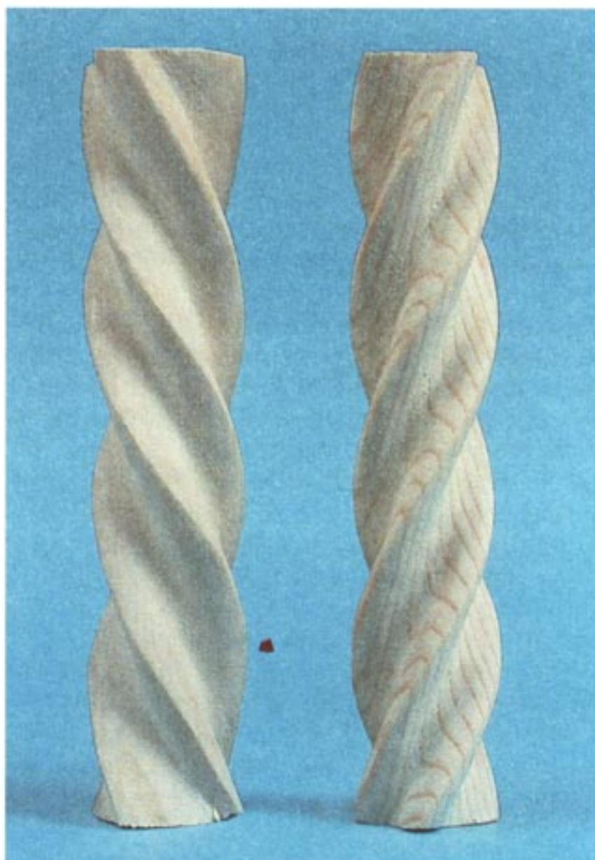
Рис. 8. Правая и левая направленности прорезки винта
