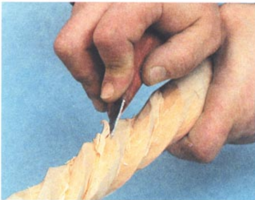
Рис. 123. Чистовая прорезка граней на заготовке с одной стороны
