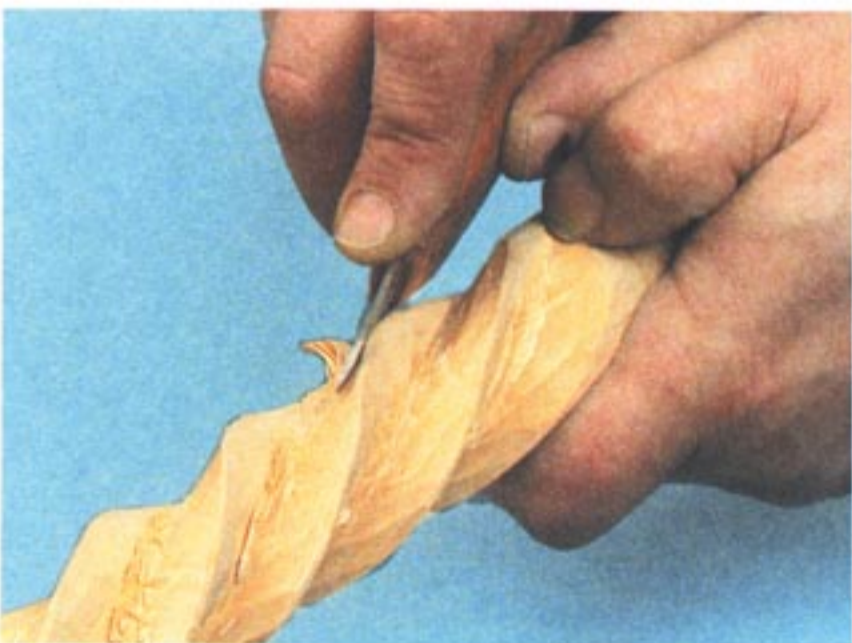
Рис. 124. Чистовая прорезка граней после разворота заготовки
