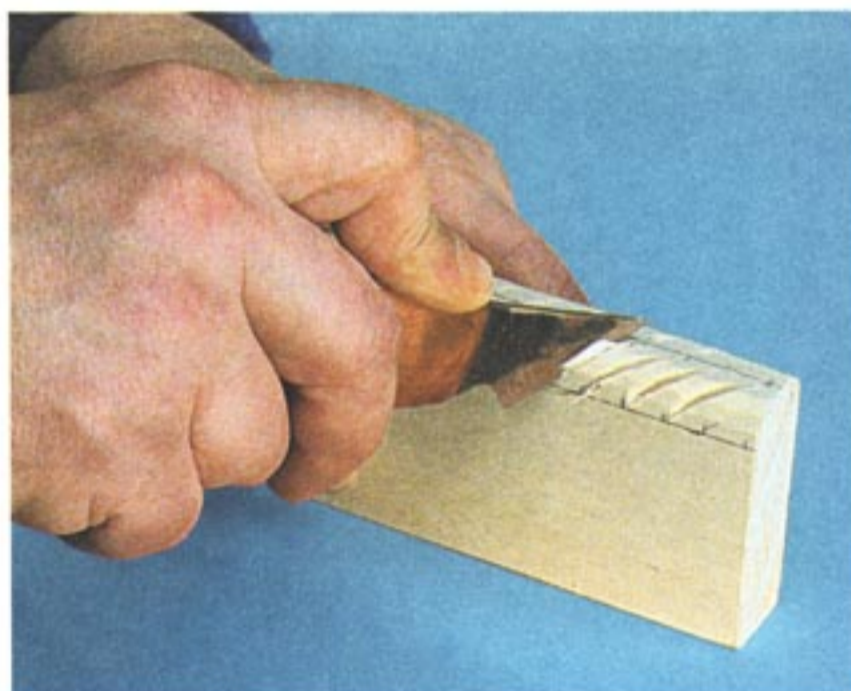
Рис. 82. Прорезка первой грани бруска ножом-косяком
