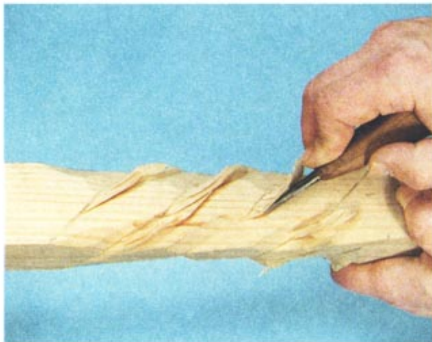
Рис. 102. Грубый черновой сквозной проход по линии захода от начала до конца
