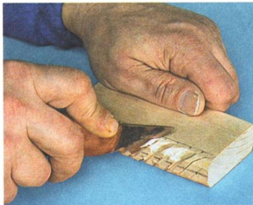
Рис. 85. Прорезка первой грани ножом-косяком после разворота бруска
