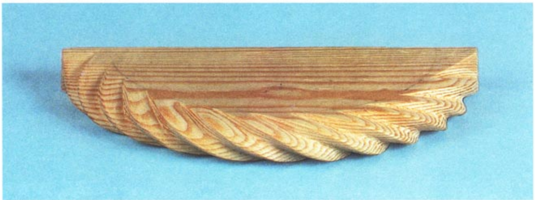
Рис. 89. 1/2 винта, прорезанная по разметке по окружности
