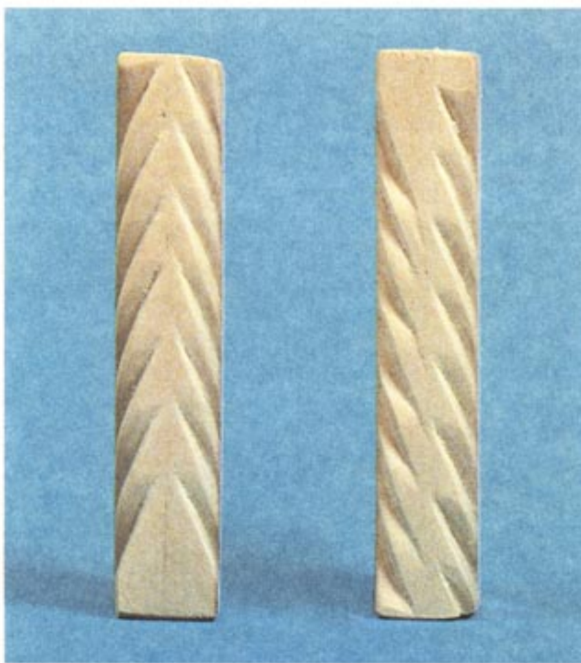
Рис. 64. Варианты прорезки по параллельной разметке на торцевой части заготовки
