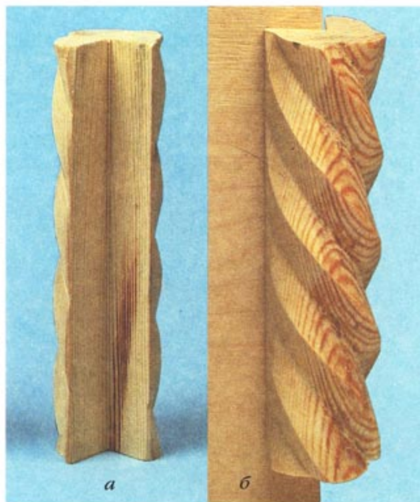
Рис. 91. 3/4 винта, прорезанные на специальной заготовке: а – вид со стороны выбранной 1/4 части; б – вид при накладке на изделие
