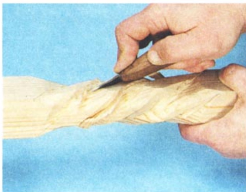
Рис. 103. Грубый черновой сквозной проход по линии захода после разворота заготовки
