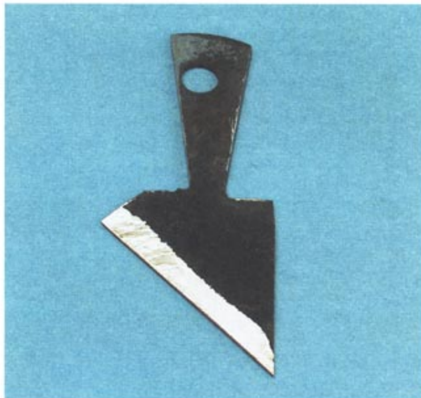
Рис. 20. Предварительно заточенное лезвие ножа-косяка
