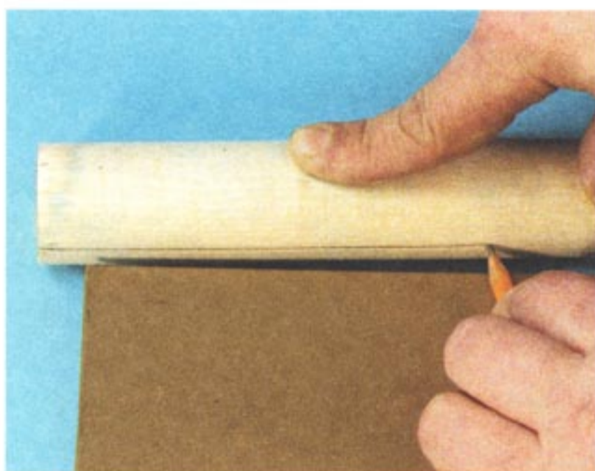
Рис. 114. Нанесение продольных линий на заготовку
