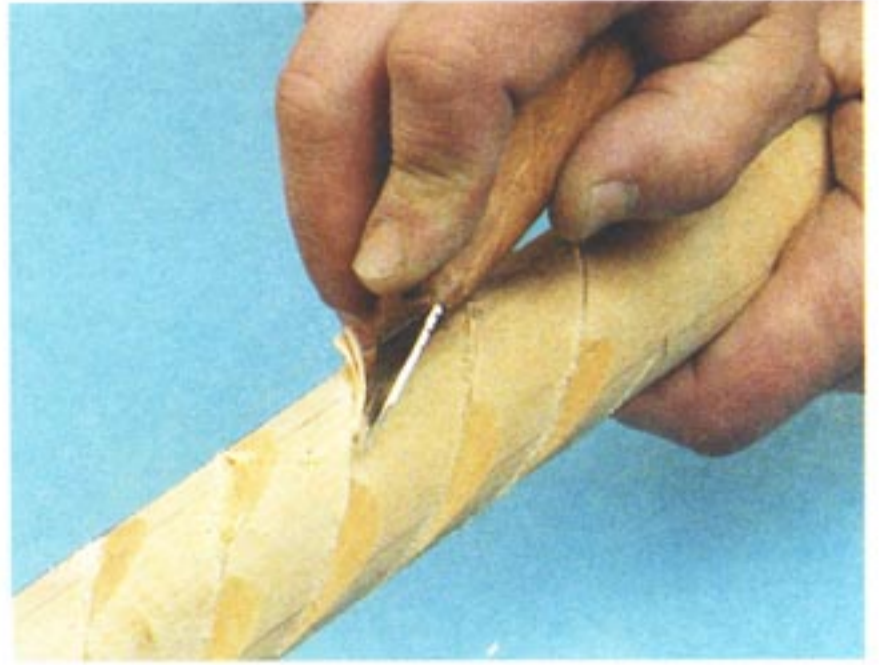
Рис. 119. Начало формирования граней (выполнение прорезки) с одной стороны заготовки
