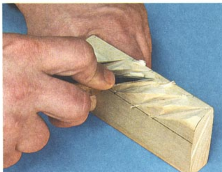
Рис. 59. Постепенная доводка прорезов до желаемой формы
