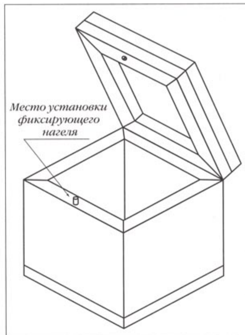
Рис. 208. Установка центрирующего нагеля на передней стороне заготовки
