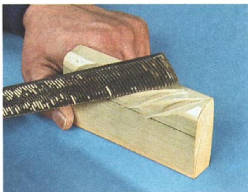
Рис. 61. Скругление сформированных прорезов рашпилем
