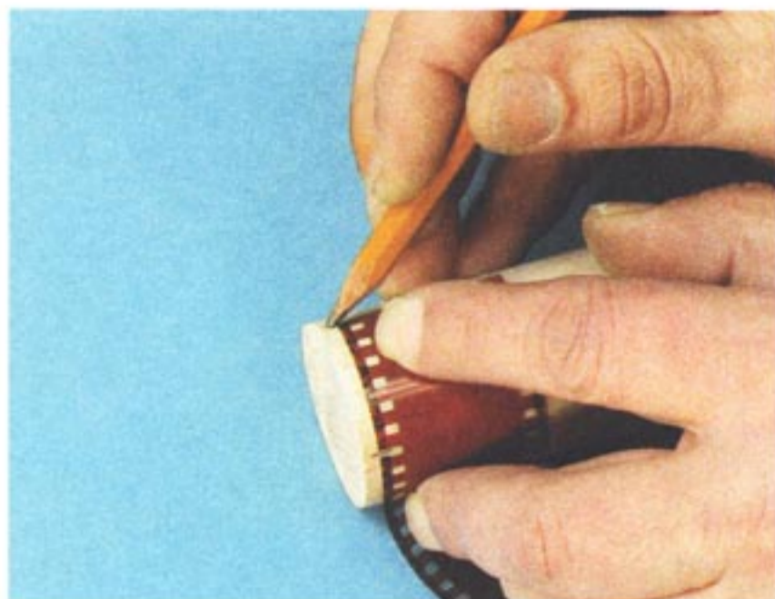
Рис. 113. Нанесение на заготовку точек, определяющих места заходов
