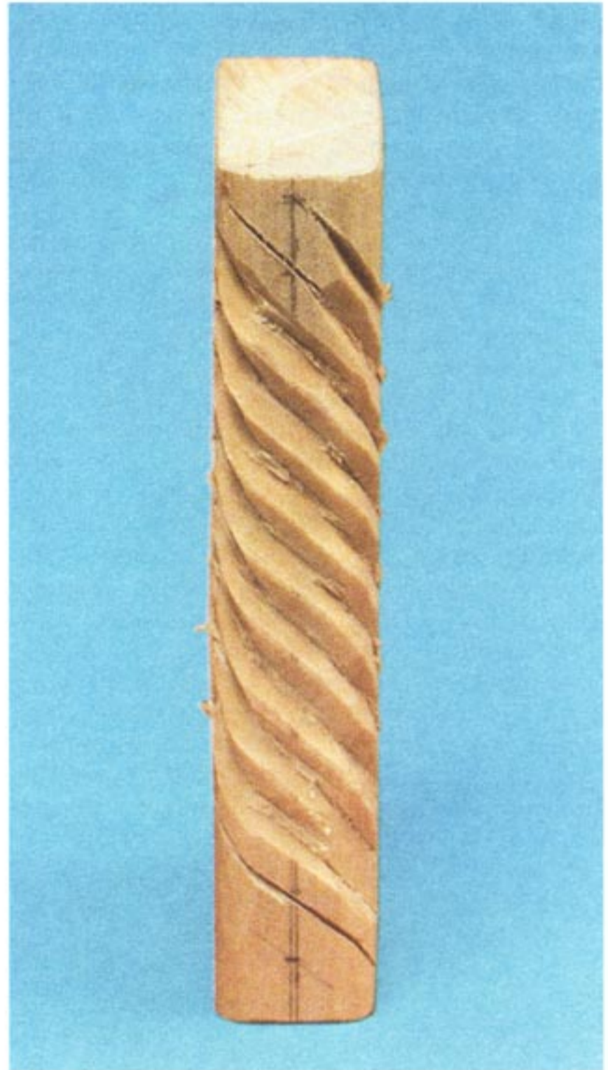
Рис. 88. Вид законченной прорезки 1/2 винта
