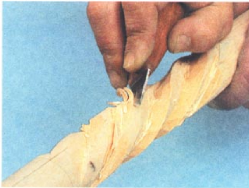
Рис. 122. Продолжение формирования граней (черновая прорезка) с другой стороны
