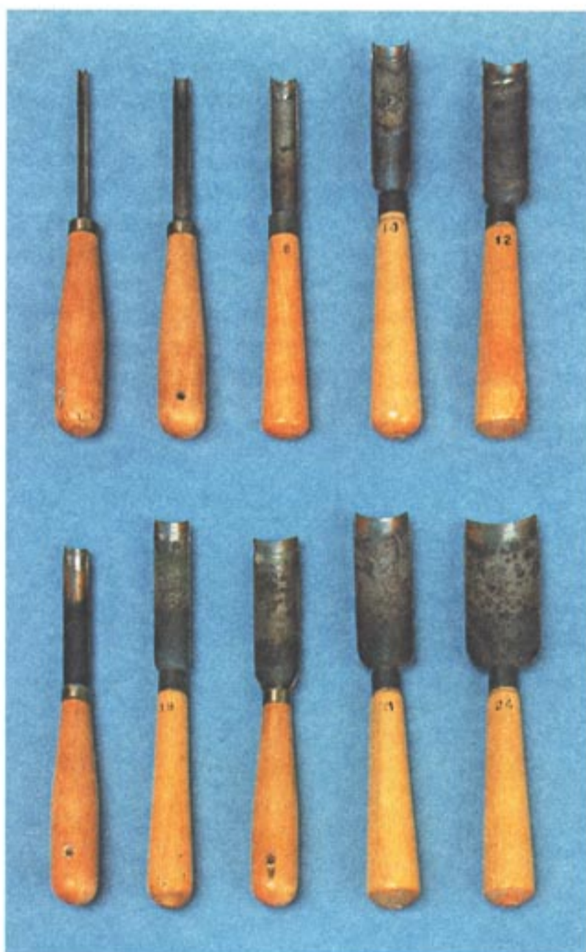
Рис. 28. Полукруглые стамески с горизонтальной режущей кромкой
