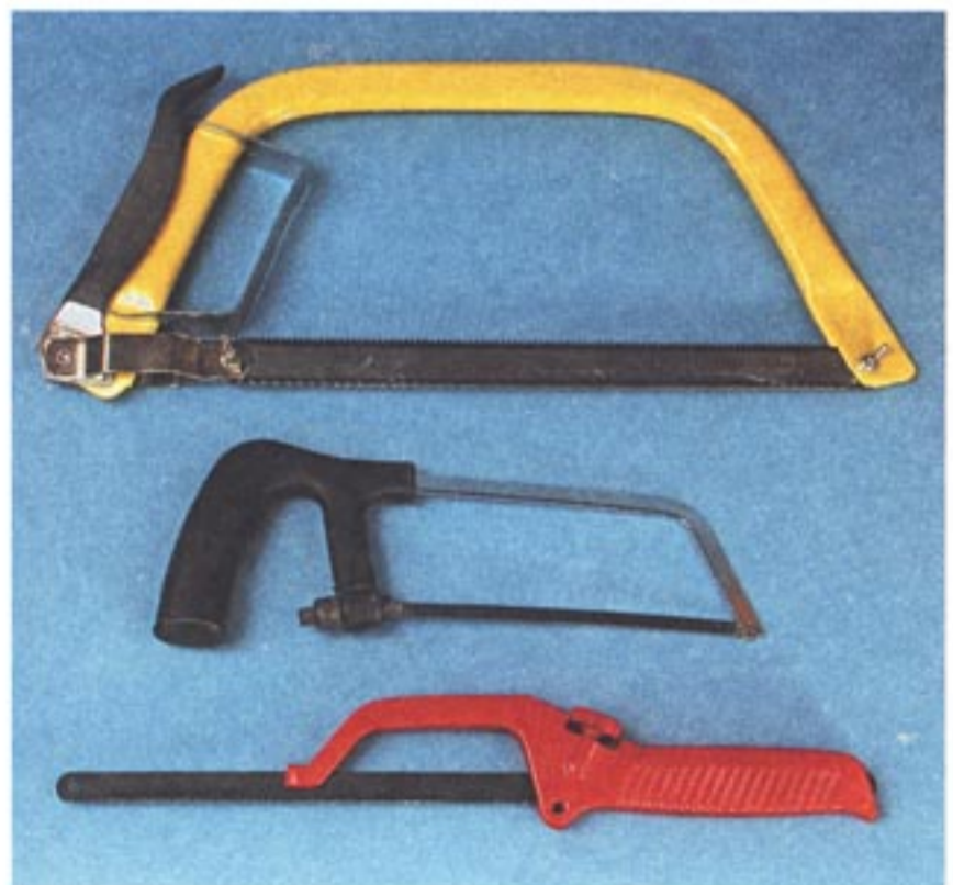
Рис. 32. Ножовки по металлу для тонкого и ровного пропила
