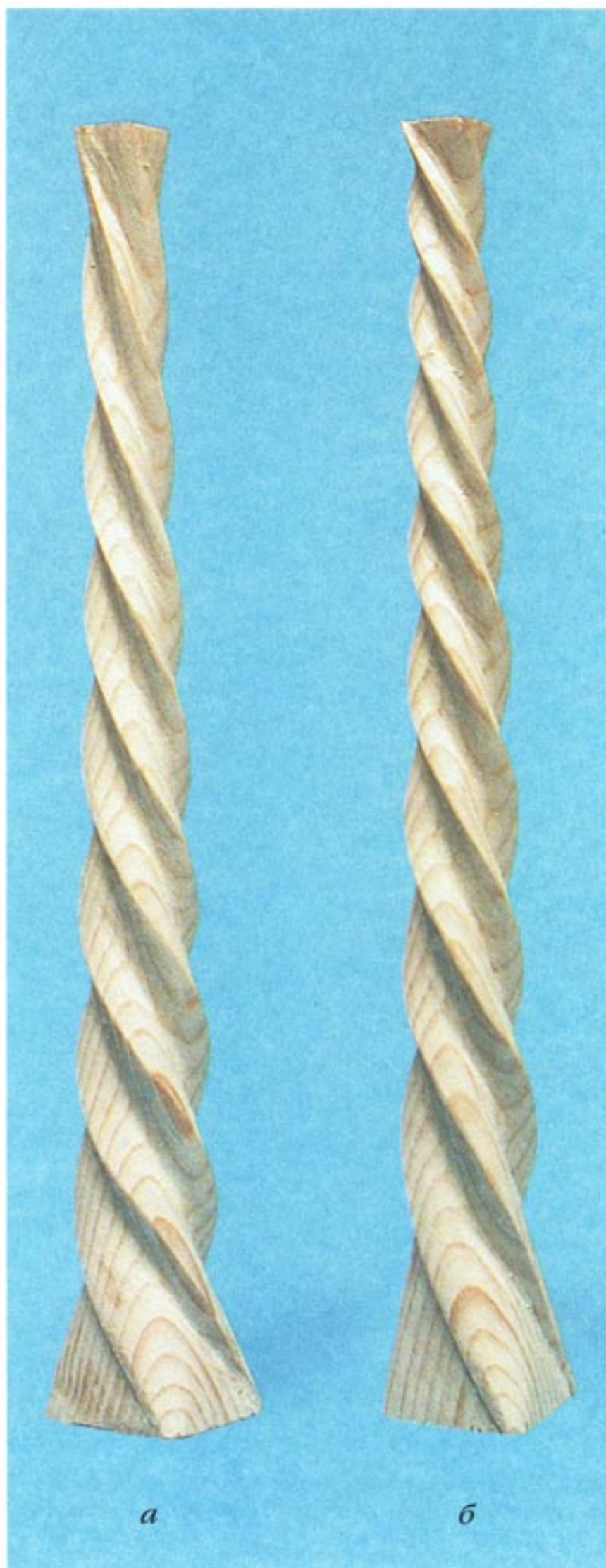
Рис. 132. Конусный винт, прорезанный на ножках по неправильной (а) и правильной (б) разметке
