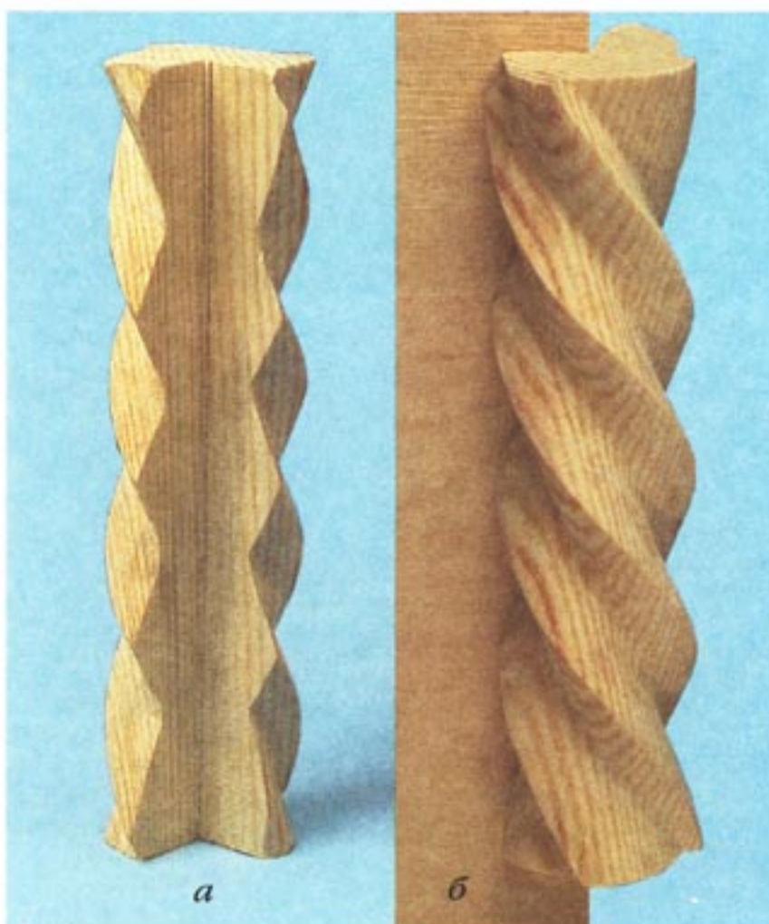
Рис. 90. 3/4 винта, изготовленные из целого винта: а – вид со стороны роспуска циркулярной пилой; б – вид при накладке на изделие
