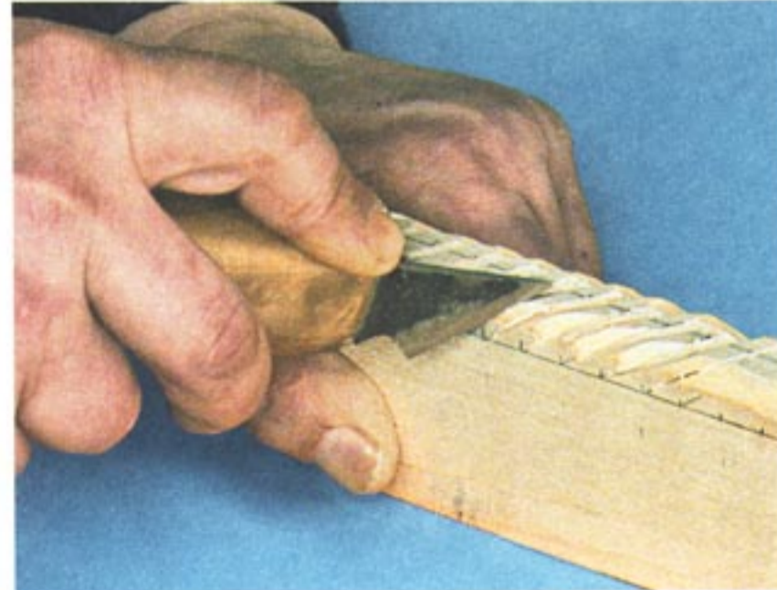
Рис. 86. Прорезка второй грани ножом-косяком после разворота бруска
