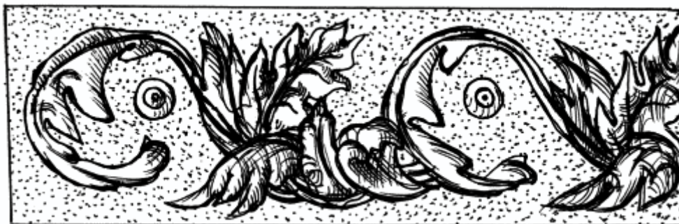
Рис. 37. Плоскорельефная резьба с выбранным чеканным фоном
