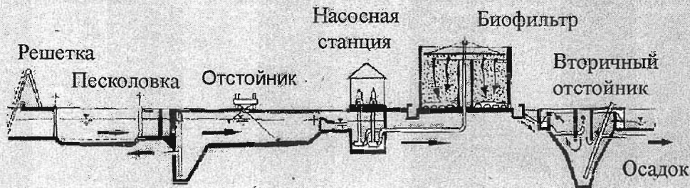
Рис. 4. Устройство очистной станции
